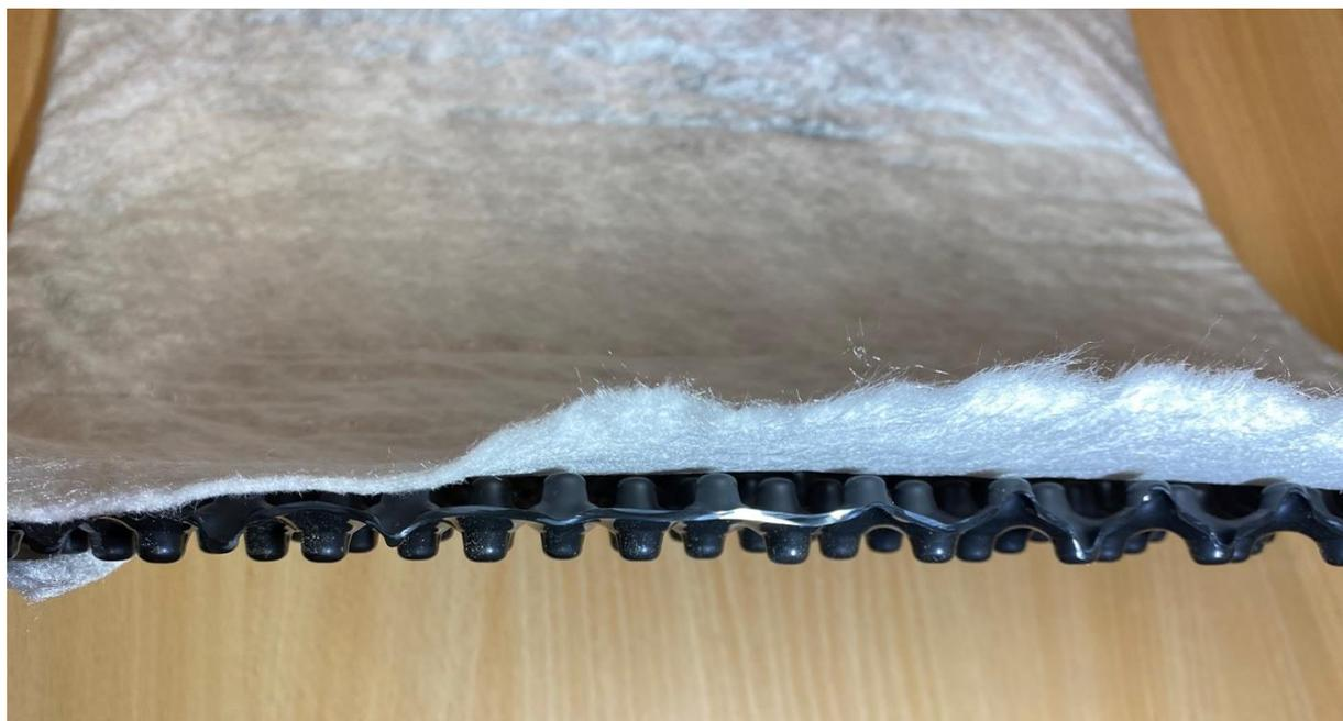
*Рисунок 9 – Общий вид и структура дренирующего горизонтального мата*
